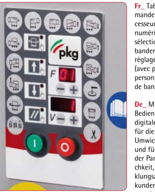
**It** Quadro comandi a microprocessore con pannello digitale per la scelta del ciclo di avvolgimento e per la regolazione dei parametri (con possibilità di personalizzare il ciclo di avvolgimento).
