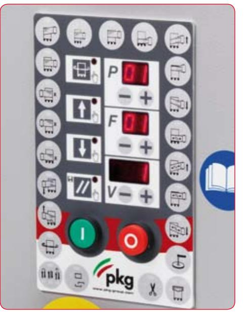
**It** Quadro comandi a microprocessore con pannello digitale con possibilità di programmare e memorizzare fino a 99 cicli di avvolgimento (Programmabili e personalizzabili in funzione delle esigenze di utilizzo).
