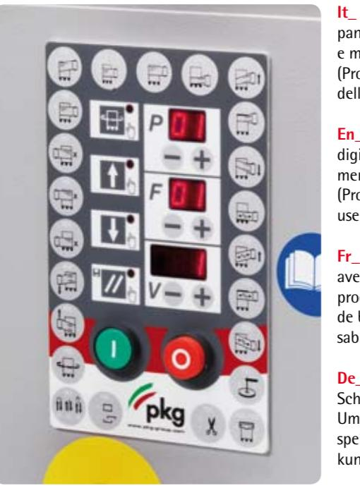
**It** Quadro comandi a microprocessore con pannello digitale con possibilità di programmare e memorizzare fino a 99 cicli di avvolgimento (Programmabili e personalizzabili in funzione delle esigenze di utilizzo).
